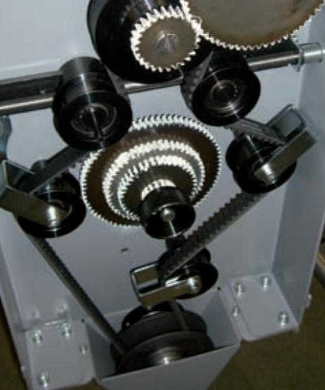
Зубчатые ремни используются в текстильной промышленности в различных исполнениях и профилях: небольшие зубчатые ремни из хлоропрена в качестве привода веретен в текстурирующих машинах или зубчатые ремни для передачи высокой мощности в крупногабаритных профилях в качестве главных приводов, вплоть до зубчатых ремней из полиуретана, например, сварные конечные ремни в кругловязальных машинах. Ассортимент очень разнообразен, а возможности применения практически не ограничены.
