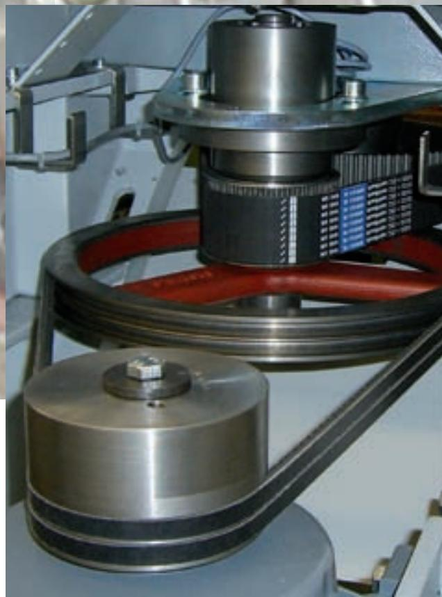
Например, фирма Mayer & Cie., ведущий мировой производитель кругловязальных машин, использует в своих вязальных машинах и машинах конечного дублирования зубчатые ремни для передачи высокой мощности Optibelt OMEGA HL 1040 8M 50.
