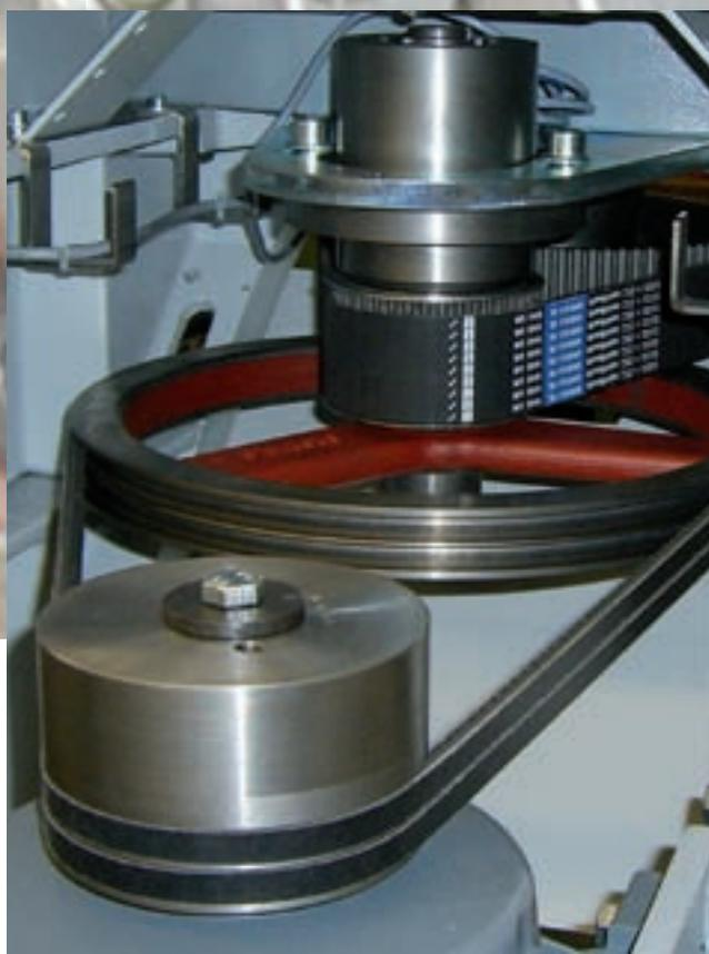
Например, фирма Mayer & Cie., ведущий мировой производитель кругловязальных машин, использует в своих вязальных машинах и машинах конечного дублирования зубчатые ремни для передачи **ВЫСОКОЙ МОЩНОСТИ**
