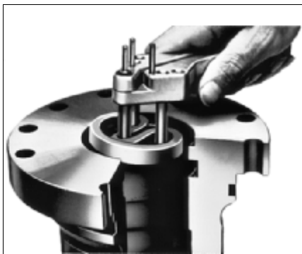
Рис. 6.22 Монтажная оснастка для уплотнений штока
