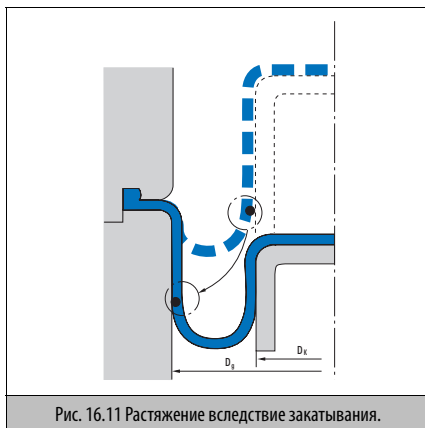
Рис. 16.11 Растяжение вследствие закатывания.
