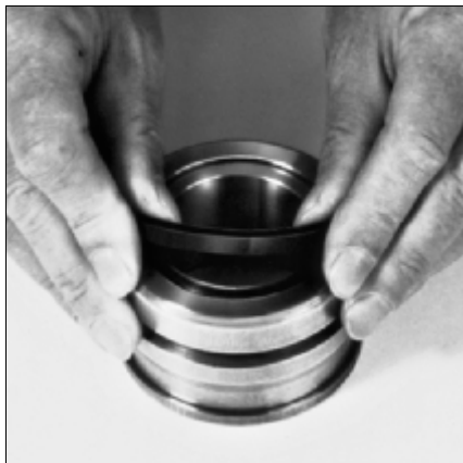
Рис. 4.28 Надевание натяжного кольца
