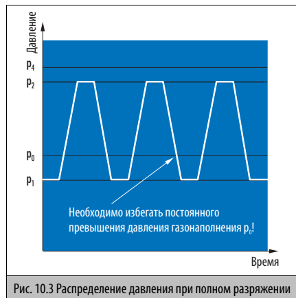
Рис. 10.3 Распределение давления при полном разрядении
