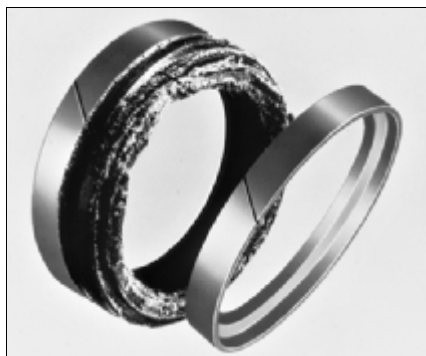
Рис. 4.18 Экструзивный износ компактного поршневого уплотнения
