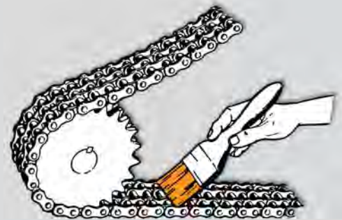
Рис. 3: Смазка цепи при помощи кисти.
