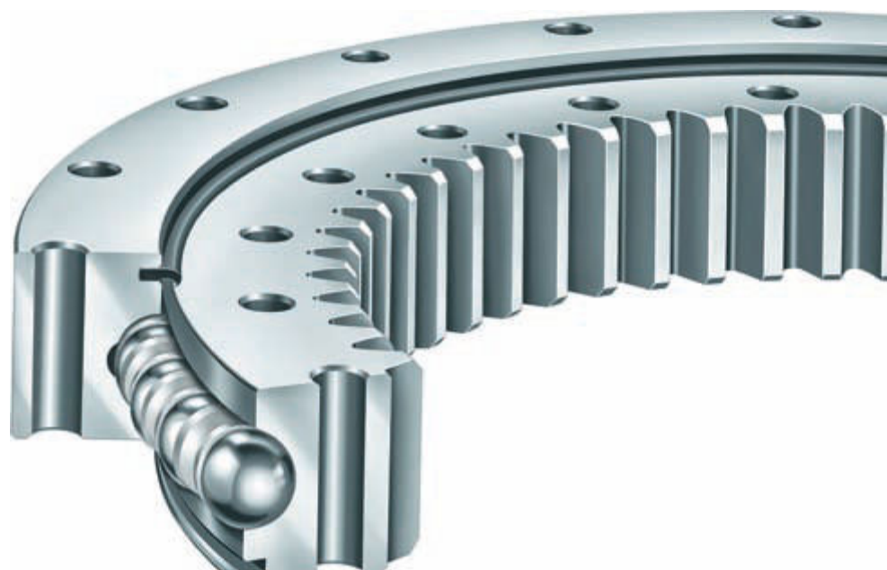
Надежное решение: опора барабана для намотки рукава выполнена на основе подшипников INA с четырехточечным контактом (фото: Bauer AG)
