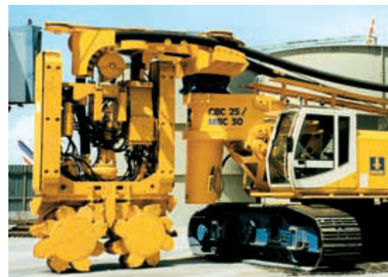
Надежное решение: опора барабана для намотки рукава выполнена на основе подшипников INA с четырехточечным контактом (фото: Bauer AG)
