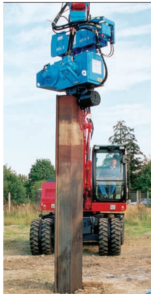
Динамичность: подшипники LSL способны работать с большими ускорениями, что особенно важно в вибропогрузателях (фото: ThyssenKrupp)
